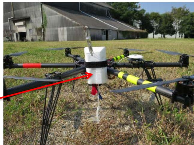
図 GPSゾンデ発信機のUAV搭載例
