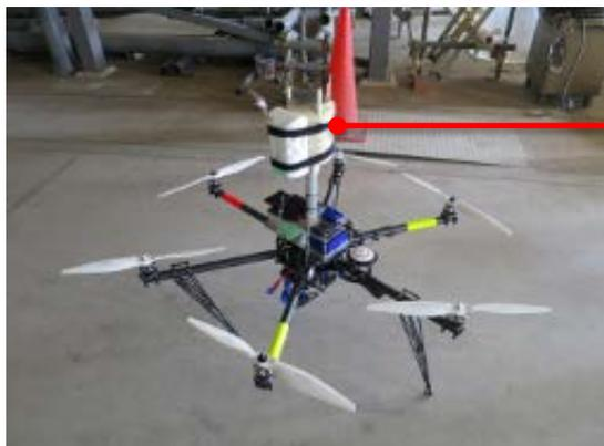
小型の超音波風向風速計をUAVに搭載して、上空の風を直接観測
